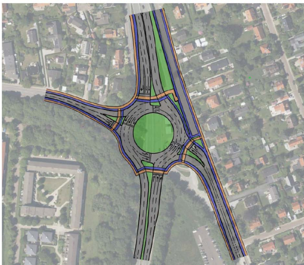
Figur 7. Ideskitse til udformning med en signalreguleret rundkørsel i et plan.
