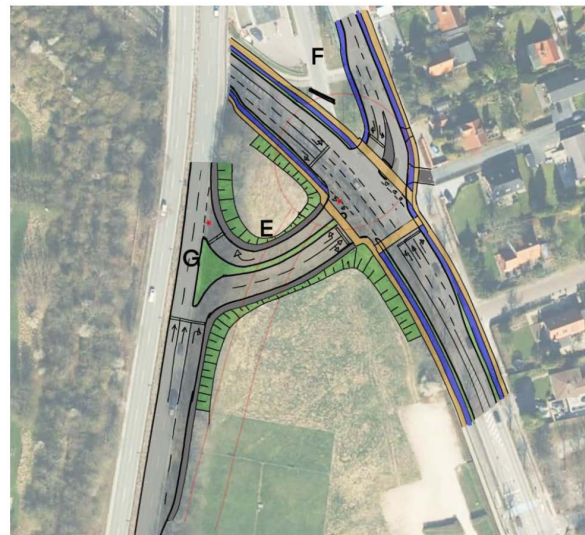
Figur 5. Ideskitse til dobbeltrettet vej mellem Lyngby Omfartsvej og krydset Virumvej/Kongevejen og med signal i begge ender.
