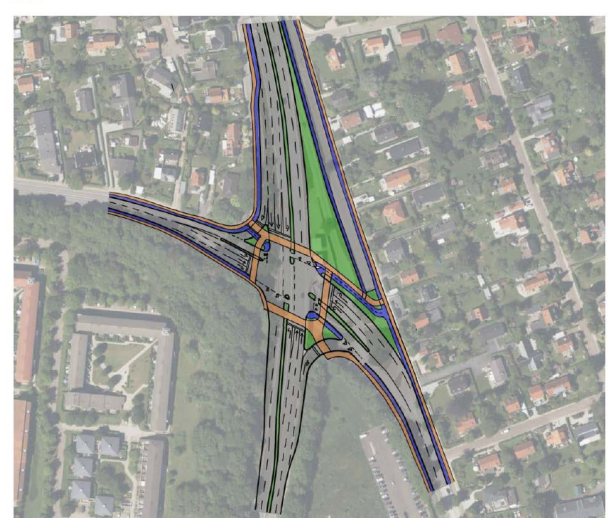
Figur 8. Ideskitse med signalreguleret fire-benet kryds i et plan
