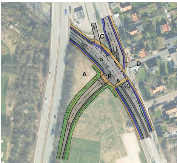
Figur 4. Ideskitse til krydsudformning Virumvej/Kongevejen/Nordvendt frakørselsrampe fra Lyngby Omfartsvej
